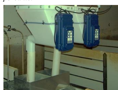
Počítačový systém krmenia pre predvýkrm a výkrm ošípaných
