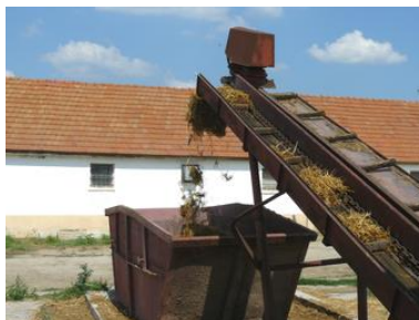
Vynášací dopravník maštalného hnoja pri plnení kontajnera
