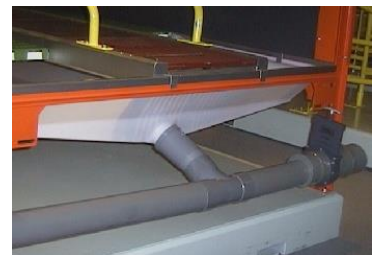
Kalová vaňa s odtokovým potrubím a uzáverom
