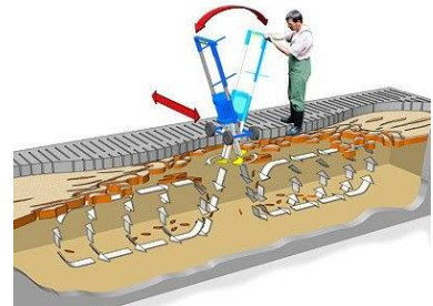
Podroštový mixér na homogenizáciu hnojovice
