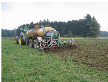
Najefektívnejšia aplikácia hnojovice je podpovrchová zapravenie do pôdy
