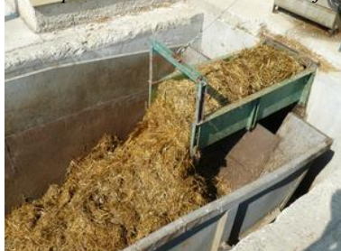
Vytlačanie hnoja do kontajnera priamovratným zhrňčom
