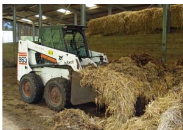
Univerzálny čelný nakladač pre manipuláciu s podstielkou a hnojom
