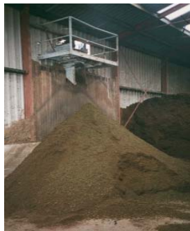
Pevná časť odseparovanej hnojovice (kal)
