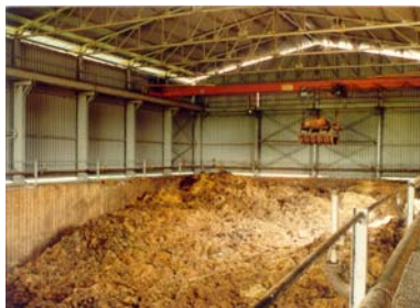
Zastrešené hnojisko s možnosťou vrstvenia hnoja do výšky 6 m pomocou mostového žeriavu
