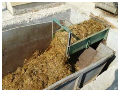
Vytláčanie hnoja do zapusteného kontajnera priamovratným zhrňovačom
