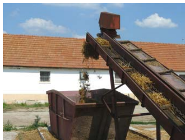
Vynášací dopravník maštalného hnoja pri plnení kontajneru
